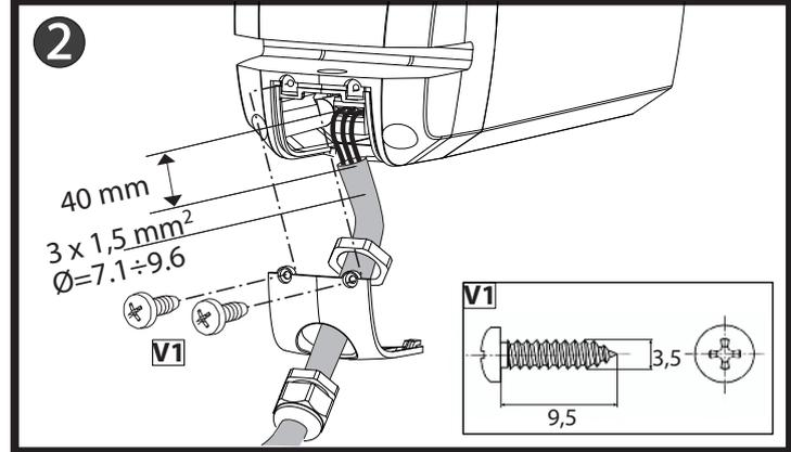
**FISSAGGIO MOTORE SU ANCORAGGIO A PILASTRO. ATTACHING MOTOR TO FASTENING ON PILLAR. FIXATION DU MOTEUR SUR L'ANCRAGE SUR LE PILIER.**
