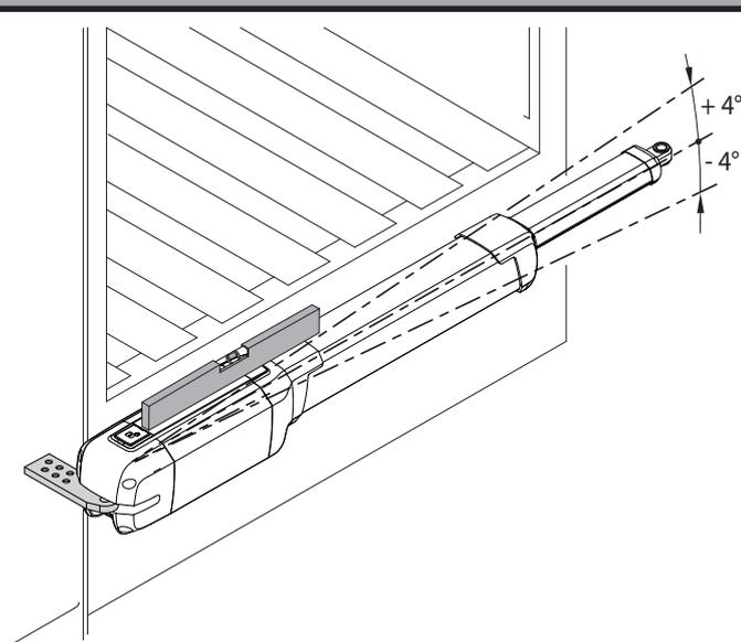
**MASSIMA INCLINAZIONE. MAXIMUM TILT. INCLINAISON MAXIMUM. MAX. NEIGUNG. INCLINACIÓN MÁXIMA. MAXIMUM HELLING.**
